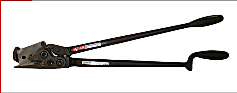
Bandavklippare CU-25 med vändbar och utbytbar övre kniv för alla typer av stålband upp till 32 x 1,3 mm Art nr 0005740
